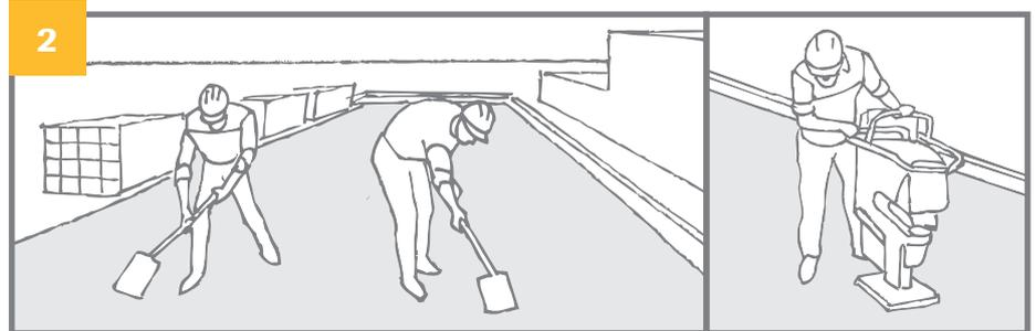
Se extenderá material granular 0-20 de manera uniforme en toda el área a pavimentar, compactando correctamente toda la superficie. Se deben respetar las pendientes mínimas de 2% hacia los bordes
