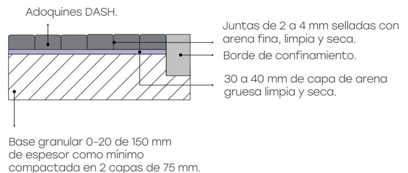
Importante: para su colocación con cama de arena se requiere compactación con plancha y compactadora con accesorio de goma.
